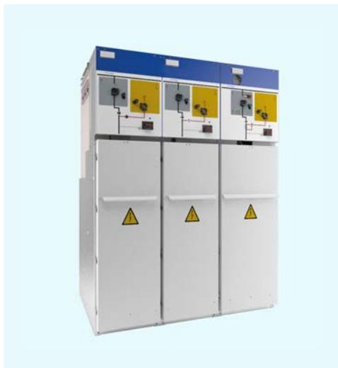
Die **cgm.3**-Felder bis 40,5 kV / 38 kV (IEC/IEEE) Bemessungsspannung sind in zahlreichen, sowohl modularen als auch kompakten Modellen verfügbar, die entsprechend den wichtigsten internationalen Normen konstruiert wurden. Die Bauweise der cgm.3-Felder umfasst ein Schaltgehäuse aus Edelstahl, das während der gesamten Lebensdauer hermetisch verschlossen ist.
